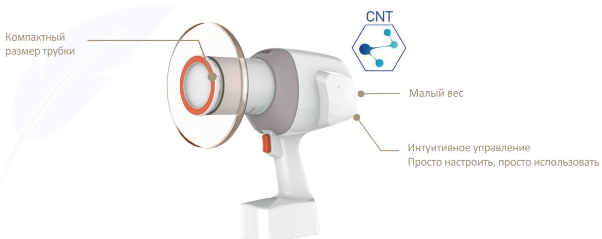
EzRay Air Vet использует технологию Carbon nanotube для получения диагностических изображений с высоким разрешением. Рентгеновские трубы CNT функционируют более эффективно, чем традиционные трубы, устранив высокие температуры, связанные с термоэлектронной эмиссией, необходимой для рентгеновского облучения.
