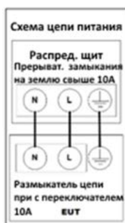
Центральный пульт распределения с размыкателем цепи
